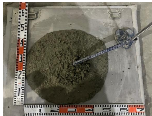
【中流動繊維補強コンクリート】
